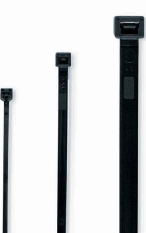
Schwer entflammbare, selbst verlöschende Kabelbinder für Einsatzbereiche mit besonders hohen Forderungen an den Entflammwiderstand. Flammwidrigkeit gemäß UL 94 V-0: Das flammwidrige Material darf nicht länger als 10 Sekunden brennen und darunter liegende, brennbare Materialien nicht entzünden. Halogenfrei, Temperatur-Einsatzbereich von -20 Grad C bis +80 Grad C. Farbe milchweiß, Breite 4,5mm, Länge 360mm, KabelBaumdurchmesser 5-101mm, Mindestzugfestigkeit 17kp/173N.
