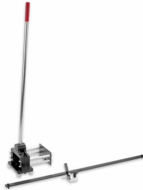
DIN Profil Schneid- und Stanzgerät mit G-Profil Zum gratfreien Ablängen ohne Abfall -
