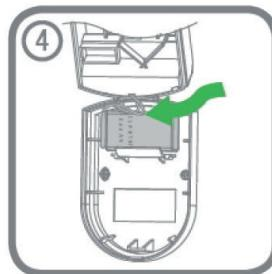
Raccorder la pile et l'insérer dans l'ouverture prévue.
